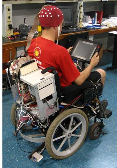
**Figura 4-25.** Silla de ruedas robótica controlada por SSVEP.
