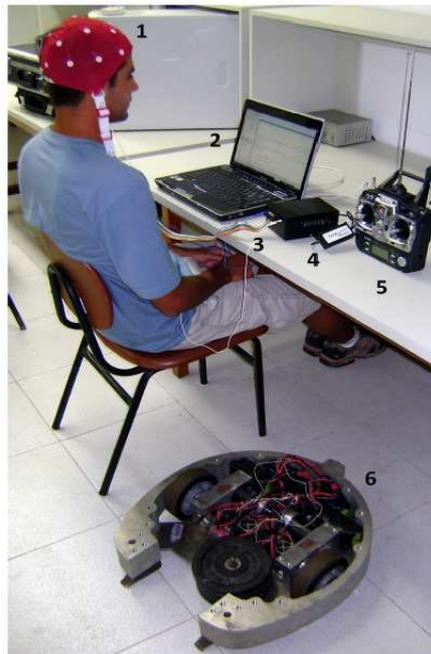
**Figura 4-18.** Sistema BCI para mover un robot en cuatro direcciones.
