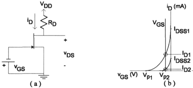
Figura 4.9: a) Circuito de polarización fija; y b) curvas de entrada de dos JFETs y recta de carga del circuito de polarización.
